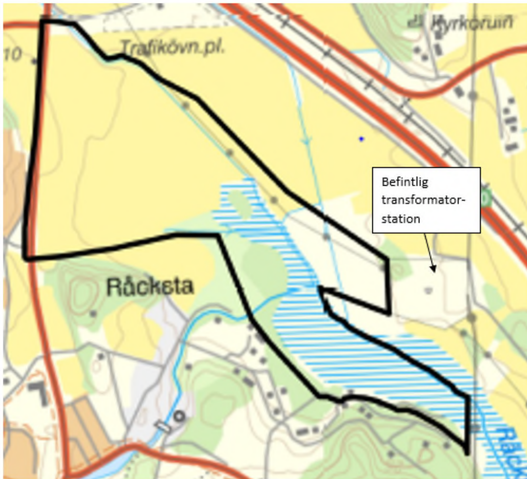
Figur 3. I östra delen av planerat verksamhetsområde går befintlig kraftledning fram till befintlig transformatorstation. Solenergianläggningen kommer troligen att anslutas med kabel i den befintliga ledningsgatan till denna transformatorstation.
