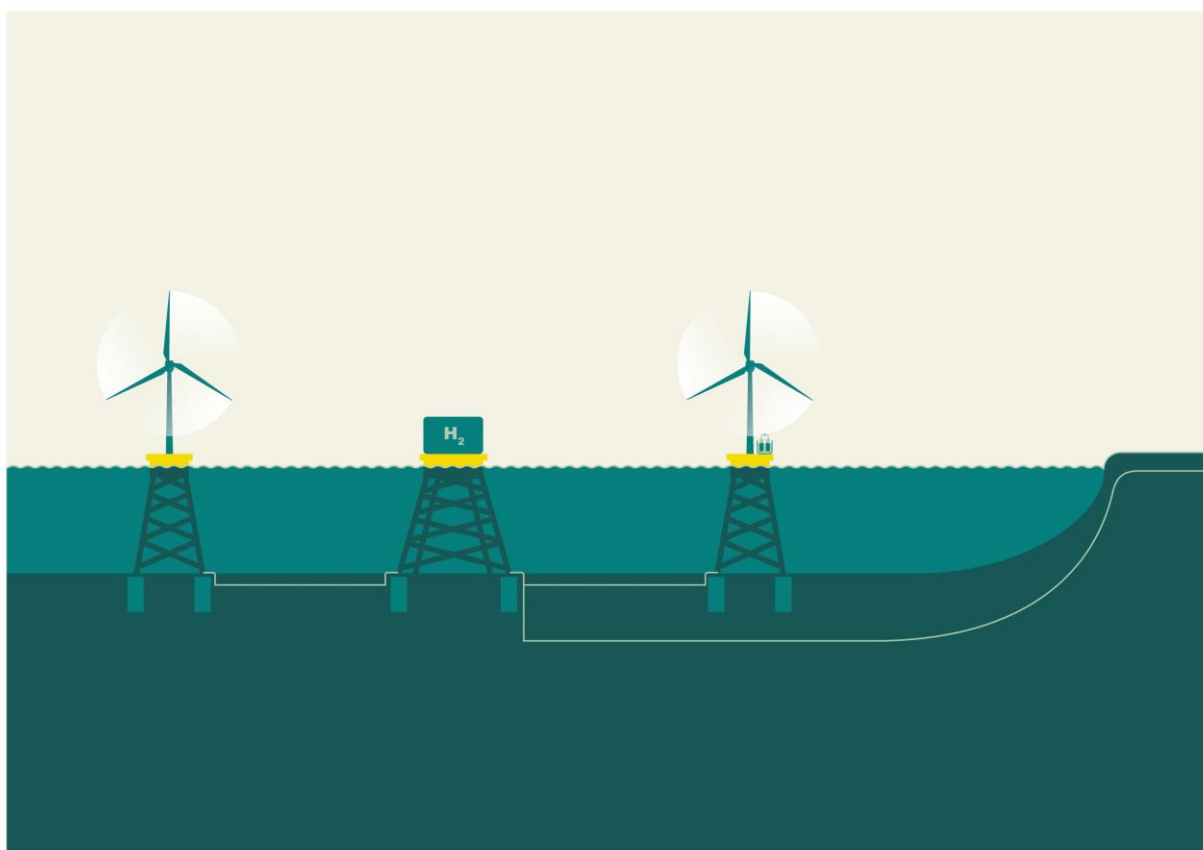
Figur 7. En schematisk översikt komponenter kopplade till vätgasproduktion, både vätgasproduktion på plattform i parken (centraliserad) och vid vindkraftsfundamentet (decentraliserad).
