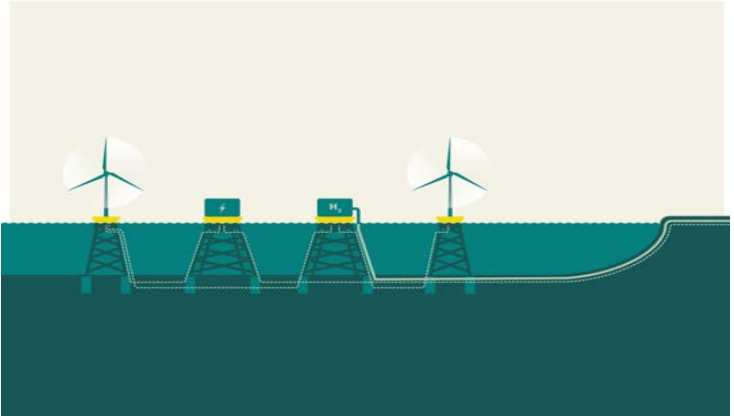
Figur 5. Principskiss med de olika delar som en energipark (centraliserad layout) typiskt sett består av. Illustratör: Nina Fylkegård
